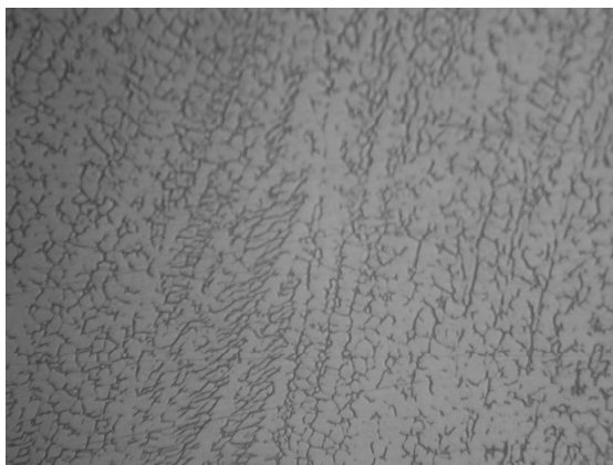
Figura 1: Microestrutura ao longo do metal base. Aumento de 1000X. Aporte: 1,20 KJ/mm
